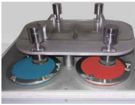
Les matières ERIMA à base de latex sont testées selon la méthode Martindale. La résistance à l'usure et le maintien du grip sont vérifiés à l'aide d'un papier de verre que l'on frotte sur la matière dans un mouvement circulaire et avec une légère pression.
